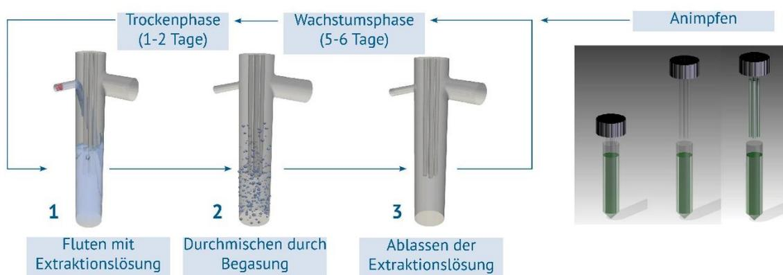
**Abbildung 2: Semikontinuierlicher Prozess zur EPS-Produktion unter Anwendung des ePBR.** Nach dem Animpfen, durch Eintauchen der Glasstäbe in eine Zellsuspension, folgt das Wachstum der Organismen. Eine nachfolgende Trockenphase unterstützt die EPS-Produktion. Der Trockenphase schließt sich die Extraktion, ausgeführt durch die Schritte Fluten des Reaktors mit Extraktionsmittel (0,14 M NaCl- und 0,2 mM EDTA-Lösung), Durchmischen durch Begasung (Luft) und Ablassen der Extraktionslösung, an.
