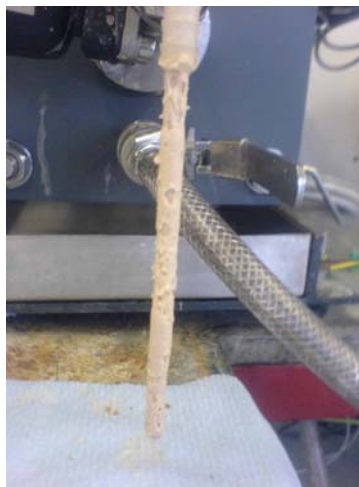
Abbildung 2: eingedickte Hefesuspension am Abschlämmventil
