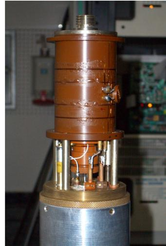
(b) Foto des Aufbaus. Zu sehen ist die Abschirmspule zur aktiven Kompensation von Wirbelströmen, die um die Hauptspule liegt.
