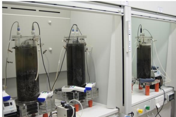
*Abb.6: Die drei während des Versuches zum Einfluss der Sandbettumwälzung eingesetzten Bioreaktoren in Betrieb*
