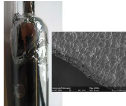
Abb. 3: Kohlenstoffablagerungen im Reaktor und REM-Aufnahme
